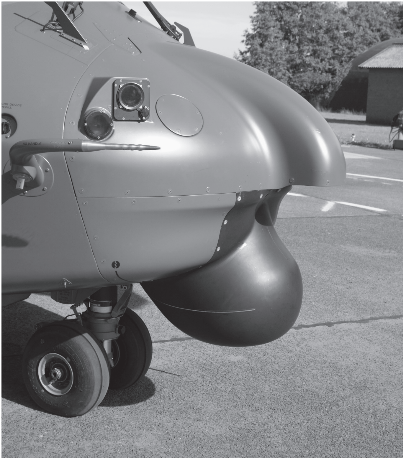
Gros plan sur le nez « becqué » typique du NH90 TTH qui se trouve juste au-dessus du radar météo.
