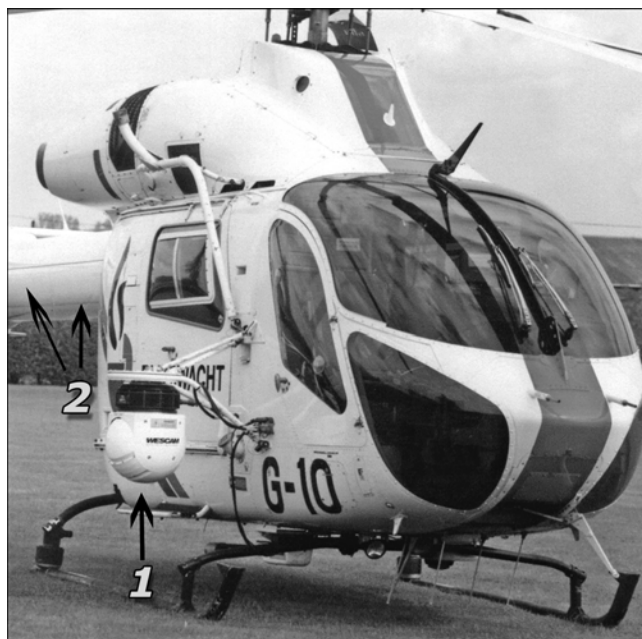
Sur un MD 900, montage latéral d'une tourelle de détection optique et infrarouge (repère n° 1). Le repère n° 2 montre sur le flanc droit de la poutre de queue la position des deux fentes d'éjection d'air du système NOTAR.
