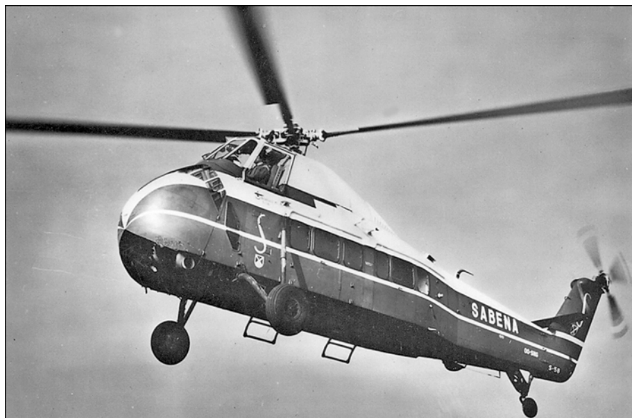
Le Sikorsky S-58, doté d'un moteur à pistons de 1525 CV, peut transporter douze passagers sur une distance de 300 kilomètres.
