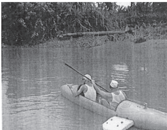
Kano gemaakt van een brandstoftank (met stabilisator) Canoë réalisé à partir d'un réservoir à carburant (avec stabilisateur)
