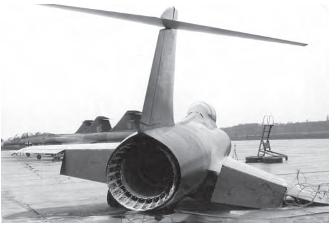
Jever, 11.05.1964. Atterrisage train rentré d'un F-104 allemand piloté par le moniteur belge Camille Goossens. Devenu incontrôlable après l'atterrissage, l'avion a quitté la piste puis a glissé sur l'herbe pendant 300 mètres avant d'aller s'arrêter.....sur l'aire de stationnement entre les F-104 au parking. (Photo C. Goossens)
