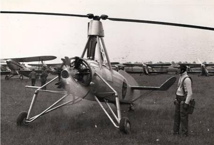
L'Espagnol Juan de la Cierva met au point sur ses autogires le premier rotor à pales articulées avec amortissement. Ici un Avro 671/Cierva C30 (n° constructeur 818) aux essais à l'Aéronautique Militaire belge à la fin des années 30 (Collection Robert Gollier).
