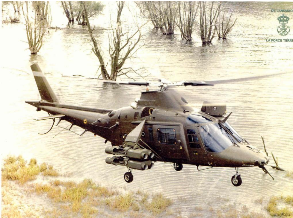
De Agusta A 109BA in de antitankversie, voorzien van de lanceerinrichtingen voor de draadgeleide missies van het type TOW 2A, met een draagwijdte van 3750 meter
