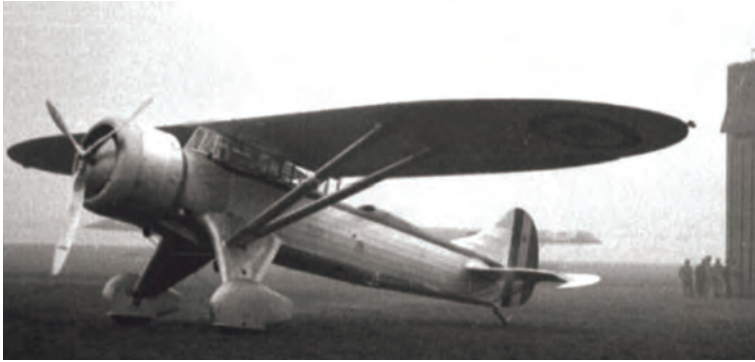
Le R-32 avec carénage et moteur Gnome.
