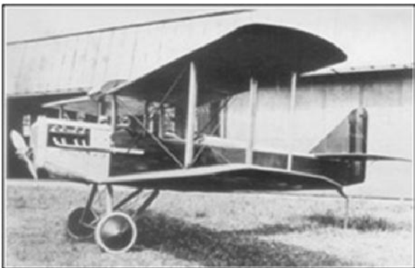
Prototype RSV 26/140 met Minerva-motor
