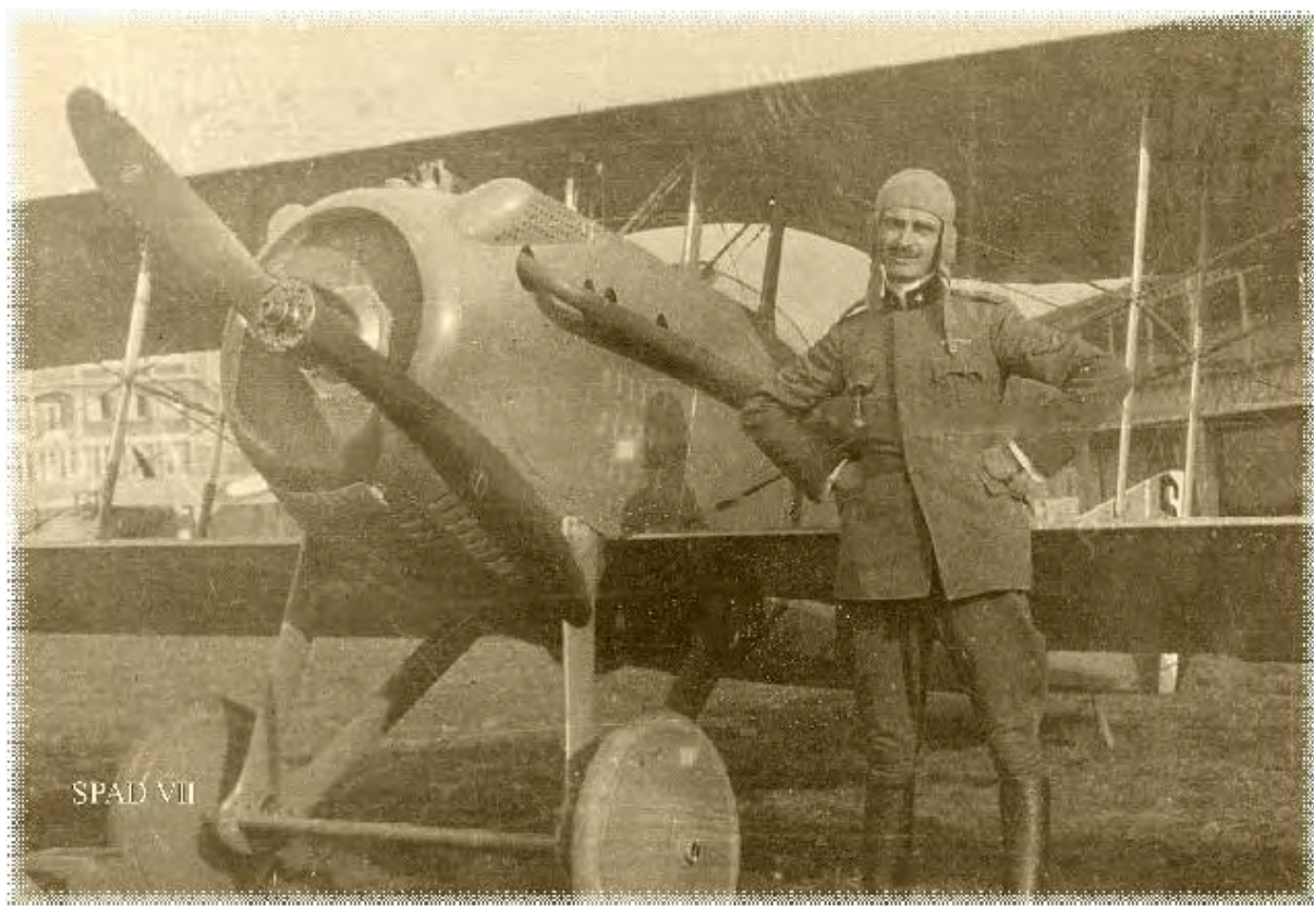
Ruffo di Calabria devant un Spad VII, chasseur biplan de construction française propulsé par un moteur Hispano-Suiza à 8 cylindres en V, utilisé sur le front italien à partir de 1917.
